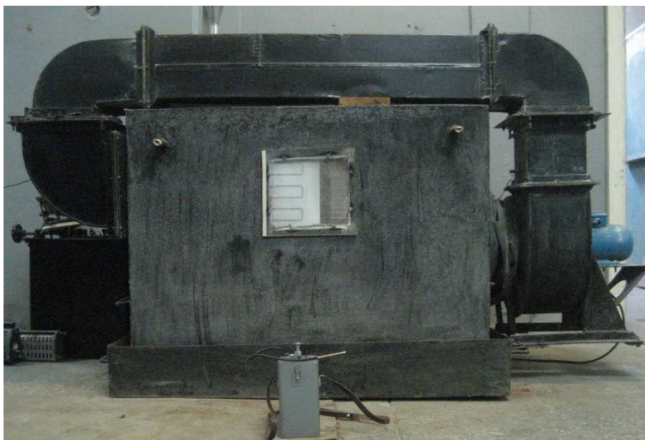
Рисунок 3.4 – Внешний вид климатической камеры с агрессивными условиями среды с помещённым в неё плёночным электронагревателем
