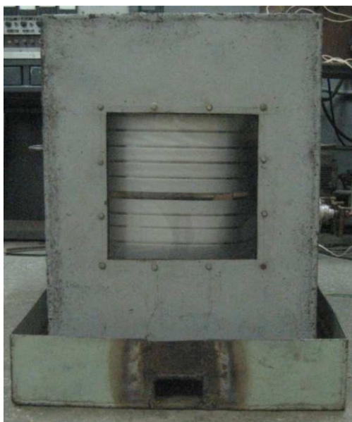
Рисунок 3.3 – Внешний вид камеры влажности с помещённым в неё плёночным электронагревателем
